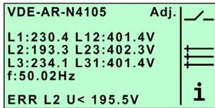
In der ersten Zeile findet sich die momentan für die Netzüberwachung gewählte Norm. Weichen ein oder mehrere Parameterwerte von der Standardeinstellung ab, wird der Text in der ersten Zeile durch "Adj" ergänzt.
