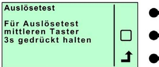
Nach erfolgreichem Test wird auf der LCD-Anzeige zusätzlich die Information "→Abschaltvorgang ausgelöst" angezeigt.
