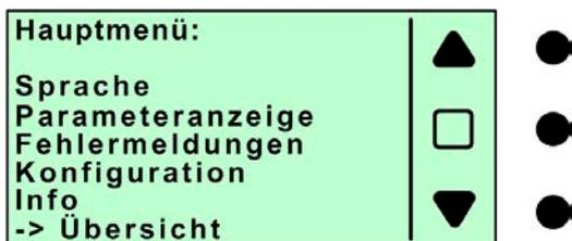
Danach dient die mittlere Taste als Enter-Taste für die Auswahl der Menüunterpunkte bzw. die anderen beiden Tasten zur Navigation.
